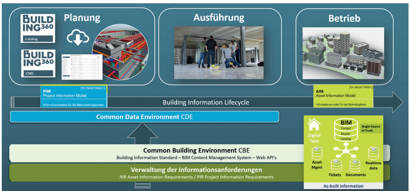
Bild 2. Informationsmanagement nach ISO 19650 auf Basis des Common Building Environments von BUILDing360
